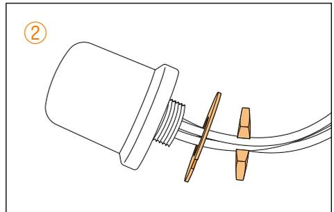
Entfernen Sie die **Mutter** und die **Unterlegscheibe** der **Antenne**.
