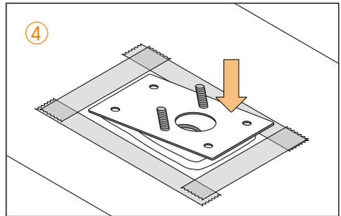
Setzen Sie die **Montageplatte** auf die Klebefläche auf und drücken Sie sie gleichmäßig fest. Falls erforderlich kann die **Montageplatte** auf dem Dach zusätzlich mit Schrauben befestigt werden.
