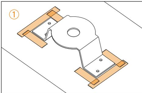
Markieren Sie die Befestigungsorte und kleben Sie entlang der Markierungen ein Klebeband im Abstand von ca. 5 mm auf. Reinigen Sie die Oberfläche gemäß den Herstellervorschriften des verwendeten Klebstoffes.
