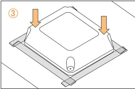
Setzen Sie die **Antenne** auf die Klebefläche auf und drücken Sie sie gleichmäßig fest. Falls erforderlich kann die **Antenne** auf dem Dach zusätzlich mit Schrauben befestigt werden.
