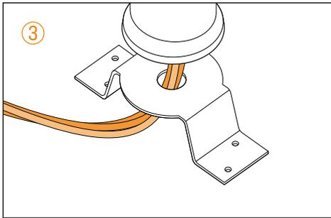
Führen Sie die drei **Antennenleitungen** von oben durch das Loch der **Antennenhalterung**.
