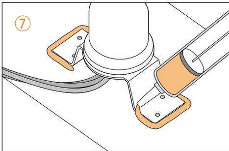
Entfernen Sie das Klebeband und tragen Sie zur Abdichtung rund um die **Halterung** sowie auf den Befestigungsschrauben bzw. den Schraublöchern eine Kleberaube auf.
