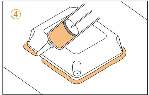
Entfernen Sie das Klebeband und tragen Sie zur Abdichtung rund um die **Antenne** eine Kleberaube auf.
