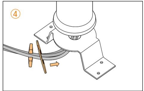
Befestigen Sie die **Unterlegscheibe** und die **Mutter** wieder. Die **Antennenleitungen** können vorsichtig durch die Einkerbungen der **Unterlegscheibe** und der **Mutter** geführt werden.
