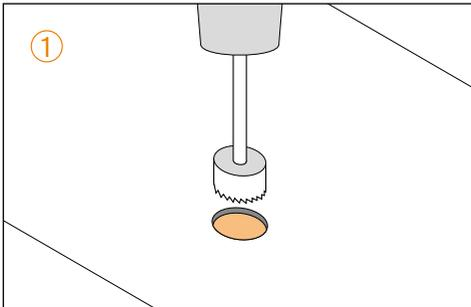
Bohren Sie mittels einer Bohrkronen ( $\varnothing 21\text{mm}$ ) mittig an der für die **Dachdurchführung** vorgesehenen Stelle ein Loch. Entgraten Sie das Bohrloch mit Schleifpapier und schützen Sie die Schnittkante gegen Korrosion.
