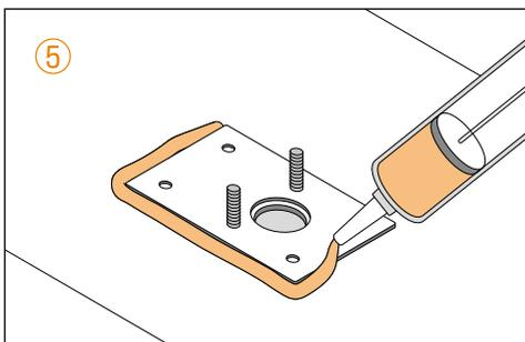
Entfernen Sie das Klebeband und tragen Sie zur Abdichtung rund um die **Montageplatte**, sowie auf den Befestigungsschrauben bzw. den Schraublöchern eine Kleberaube auf.
