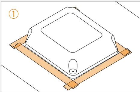
Markieren Sie die Befestigungsorte und kleben Sie entlang der Markierungen ein Klebeband im Abstand von ca. 5 mm auf. Reinigen Sie die Oberfläche gemäß den Herstellervorschriften des verwendeten Klebstoffes.
