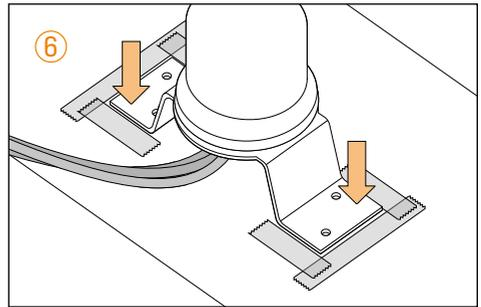
Setzen Sie die **Antennenhalterung** auf die Klebefläche auf und drücken Sie sie gleichmäßig fest. Falls erforderlich kann die **Halterung** auf dem Dach zusätzlich mit Schrauben befestigt werden.
