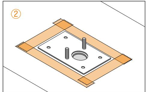
Setzen Sie die **Montageplatte** der **Dachdurchführung** provisorisch auf das Bohrloch und markieren Sie die Befestigungsorte. Kleben Sie entlang der Markierungen ein Klebeband im Abstand von ca. 5 mm auf. Reinigen Sie die Oberfläche gemäß der Herstellervorschriften des verwendeten Klebstoffes.
